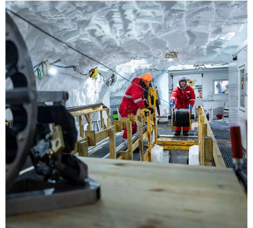
ETH-Professor Andreas Fichtner lässt ein Glasfaserkabel in ein Bohrloch hinunter, um 14 Stunden lang ununterbrochen Signale aus dem Inneren des Eisstroms aufzuzeichnen.
